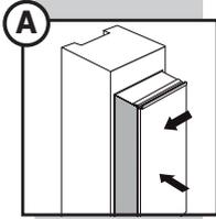
1. Gerät sorgfältig in die Einbaunische einrücken und gerade ausrichten.
