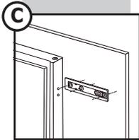
7. Die Schraublöcher der Führungsschiene auf die Möbeltür markieren. Tür muss sich dabei gut schließen und öffnen lassen.
