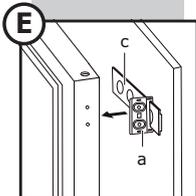
11. Winkel auf die Führungsschienen schieben und mit den kleinen Schrauben an der Gerätetür befestigen.
