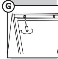
15. Obere Halterung mit den kleinen Schrauben am Einbauschränk festschrauben.
