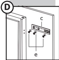
9. Führungsschiene nehmen und mit drei Schrauben an die Möbeltür schrauben (eventuell die Schraublöcher vorbohren).
