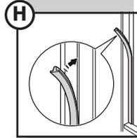
16. Gummidichtung zwischen dem Gerät und dem Einbauschränk an der Seite der Türöffnung befestigen.
