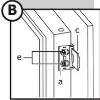
3. Winkel mit den kleinen Schrauben in die vorgesehenen Löcher der Gerätetür schrauben.
