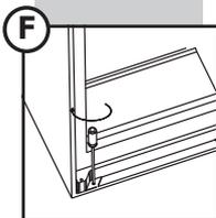
14. Untere Halterung mit zwei langen Schrauben am Einbauschränk festschrauben.
