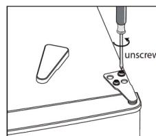
Entfernen Sie die obere linke Schraubenabdeckung.
