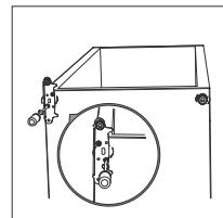
Setzen Sie die obere Tür wieder auf. Stellen Sie sicher, dass die Tür horizontal und vertikal ausgerichtet ist, sodass die Dichtungen allseitig geschlossen sind, bevor Sie das obere Scharnier endgültig festziehen.
