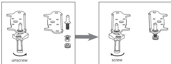
Bringen Sie die Halterung wieder an, die am unteren Scharnierstift angebracht ist. Ersetzen Sie beide verstellbaren Füße.
