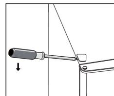
Bewegen Sie die Kernabdeckung von links nach rechts. Heben Sie dann die obere Tür an und legen Sie sie auf eine gepolsterte Oberfläche, damit sie nicht zerkratzt.
