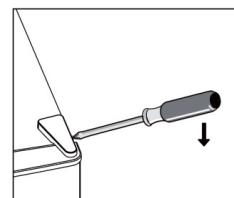
Lösen Sie die Schrauben. Entfernen Sie dann Scharnierhalterung.
