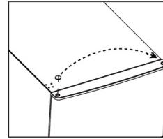
Lösen und entfernen Sie den unteren Scharnierstift, drehen Sie die Halterung um und setzen Sie sie wieder ein.
