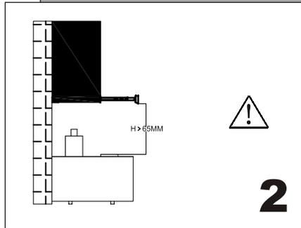
Wir empfehlen, dass die Dunstabzugshaube so montiert wird, dass sich die Unterseite der Dunstabzugshaube mehr als 650 mm und weniger als 750 mm über der Kochstelle befindet.
