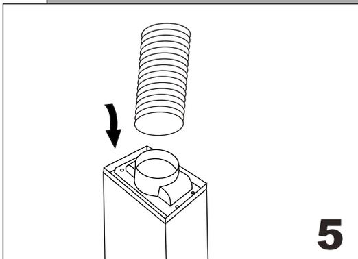
Schließen Sie den Schlauch am Luftkanal an.
