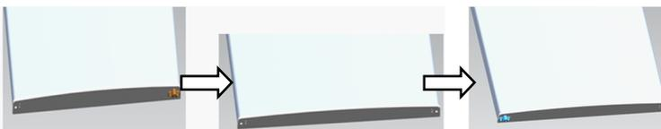
Jetzt entfernen Sie die Schrauben des unteren Scharniers und wechseln diese auf die gegenüberliegende Seite und schrauben diese zunächst locker fest.
