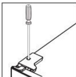
Installieren Sie die Schraublochabdeckung.
