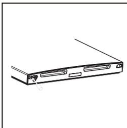
Montieren Sie die untere Türe und fixieren Sie das mittlere Scharnier.
