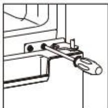
Legen Sie das Gerät auf seine Rückwand. Demontieren Sie die Stellfüsse und das untere Scharnier mit dem Kreuzschlitzschraubenzieher.
