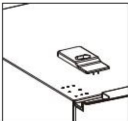
Entfernen Sie die Schrauben des mittleren Scharniers mit Hilfe des Kreuzschlitzschraubenziehers. Demontieren Sie die untere Türe.
