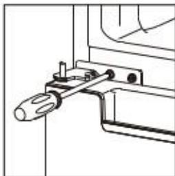
Setzen Sie die obere Türe ein, richten Sie diese korrekt aus und fixieren Sie das obere Scharnier, sowie Scharnierabdeckung.
