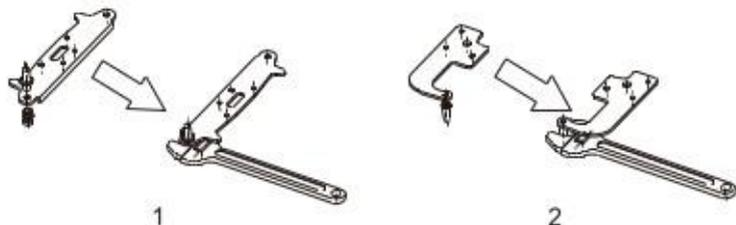
Installieren Sie das untere Scharnier gemäss folgender Abbildung und Schrauben Sie die Stellfüsse wieder an.
