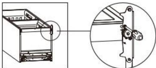
Drehen Sie das untere und obere Scharnier um 180° und setzen Sie den Bolzen wieder ein.
