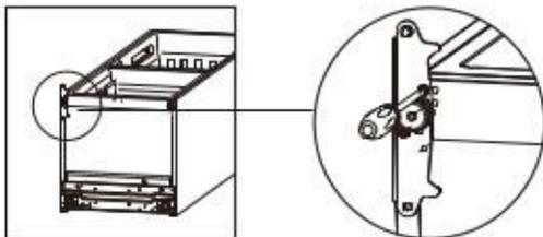
Entfernen Sie die Türdichtungen und montieren Sie diese neu, nachdem Sie sie gedreht haben.
