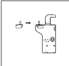
Entfernen Sie die linke Schraublochabdeckung.
