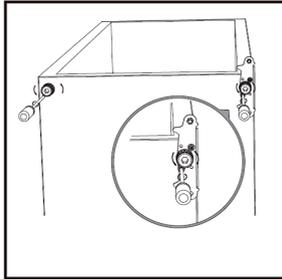
5. Entfernen Sie den Stift der unteren Aufhangung, drehen Sie die Aufhangung um 180° und schrauben Sie den Stift wieder fest.
