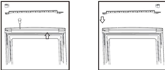
3. Entfernen Sie die mittlere Aufhängung mit dem Schraubenzieher und nehmen Sie die Tür ab.
