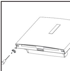
9. Installieren Sie die obere Tür und die obere Aufhängung und verlegen Sie das Kabel. Setzen Sie zum Schluss die Abdeckung für die Aufhängung auf der rechten Seite ein.
