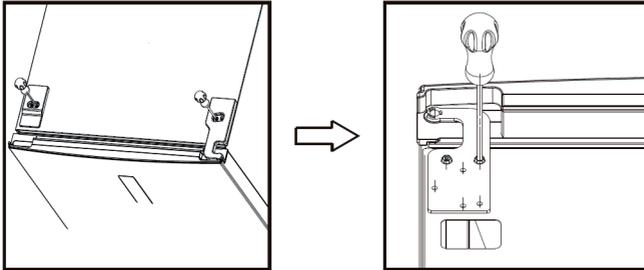
2. Nehmen Sie die Abdeckung und Leiste ab. Bitte achten Sie auf den Draht im Inneren. Bewegen Sie das Kabel und das Verbindungsstück auf die andere Seite und schrauben Sie die Leiste und die Abdeckung wieder befestigen.
