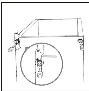
7. Setzen Sie die untere Tür ein. Drehen Sie die mittlere Aufhängung um 180° und setzen Sie den Stift oben ein. Befestigen Sie die Aufhängung an der gegenüberliegenden Seite.
