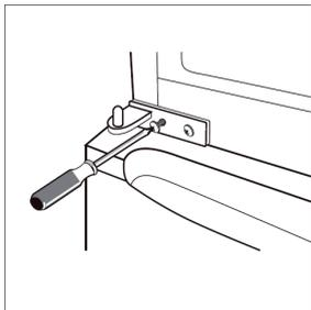
8. Entfernen Sie den Metalleinsatz an der rechten Unterseite der oberen Tür und befestigen Sie ihn auf der gegenüberliegenden Seite.
