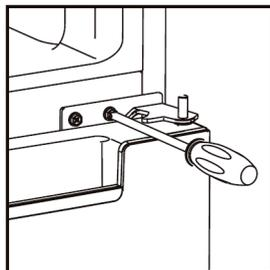
4. Leben Sie das Gerät flach hin und entfernen Sie die einstellbaren FüÙe. Schrauben Sie dann die unteren Aufhangung ab.
