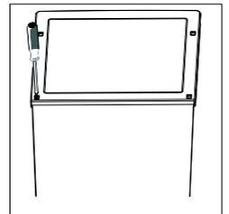
9. Entfernen Sie die Türdichtung des Gefrierschranks. Drehen Sie die Dichtung um 180° und bringen Sie sie wieder an.
