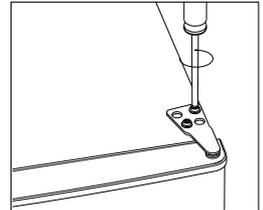
4. Schrauben Sie das untere Scharnier ab. Entfernen Sie dann den Nivellierfuß von der gegenüberliegenden Seite.
