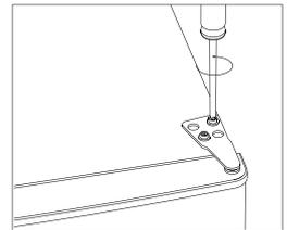
4. Schrauben Sie die Untere Aufhängung der Gefrierfach-Tür ab, entfernen Sie die Tür und stellen Sie sie auf einen weichen Untergrund.
