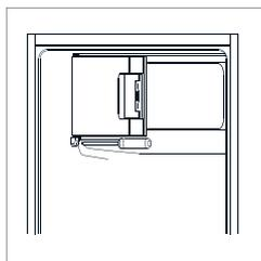
8. Schrauben Sie das untere Scharnier ab. Entfernen Sie dann den Nivellierfuß von der gegenüberliegenden Seite.
