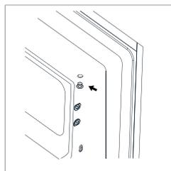
7. Drehen Sie die Gefrierfach-Tür um und befestigen Sie die Aufhängung.
