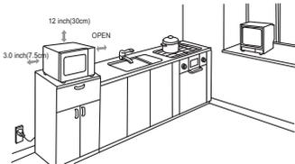
Der hinter Teil des Gerätes sollte an einer Wand angebracht werden.
