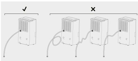
**Hinweis:** Wenn das Gerät auf einem unebenen Boden steht oder das Abflussrohr nicht richtig installiert ist, füllt sich der Behälter mit Wasser und das Wasser läuft nicht mehr ab.
