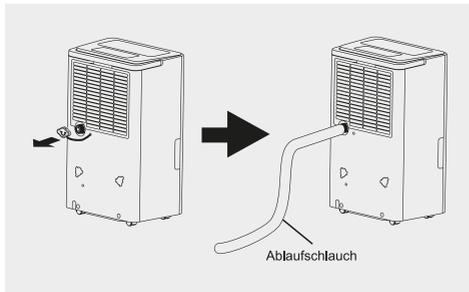
**Hinweis:** Wenn Sie die Funktion des ununterbrochenen Entleerens nicht benötigen, schrauben Sie bitte die Kappe auf die Abflussöffnung auf der Rückseite des Geräts. Das Wasser fließt dann in den Behälter.
