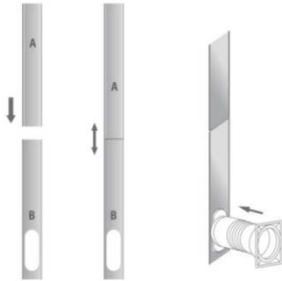
**Schritt 4:** Schließen Sie Ihr Fenster, um den Fenstermontagesatz zu fixieren. Es ist wichtig, dass der Fenstermontagesatz fest sitzt. Sichern Sie ihn bei Bedarf mit Gewebeklebeband. Für maximale Effizienz ist es empfehlenswert, den Freiraum zwischen Adapter und den Fensterseiten abzudichten.
