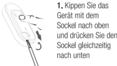
1. Kippen Sie das Gerät mit dem Sockel nach oben und drücken Sie den Sockel gleichzeitig nach unten
