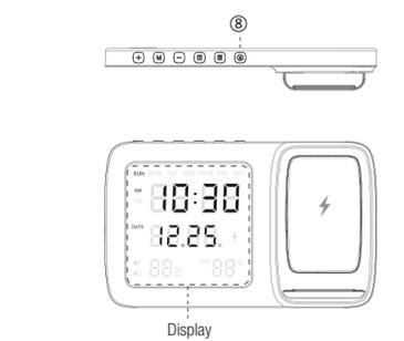
Drücken Sie kurz die Taste , um die Helligkeit der LED-Anzeige anzupassen. Der Dimmer verfügt über drei Helligkeitsstufen: Hoch, Mittel und Niedrig. Drücken Sie lange die Taste , um die LED-Anzeige ein-/auszuschalten.
